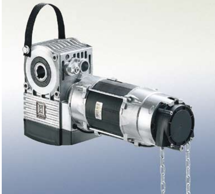
Mecanism de acționare direct pe ax WA 400 având lanț de operare în caz de urgență (acționat de la sol)
